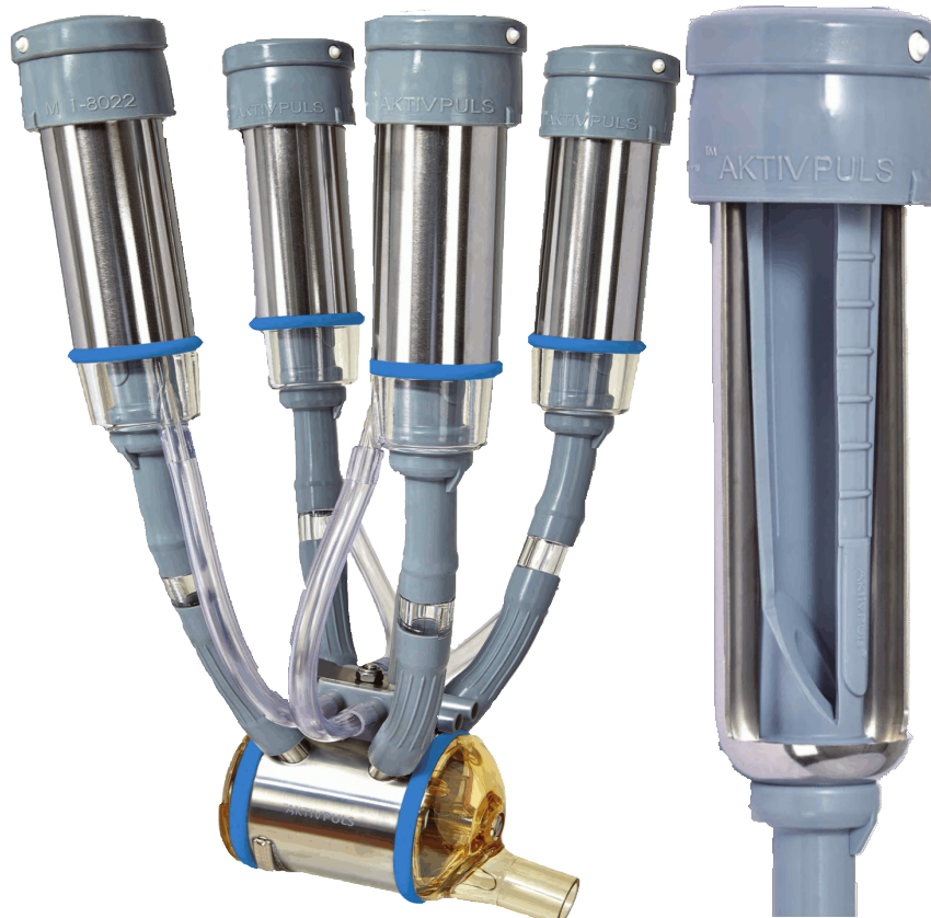
Le bas breveté du manchon AktivPuls (en bas à droite) et sa bouche à air orange (en haut à droite) permettent une réduction ciblée à un vide doux de 20 kPa au bout du trayon pendant la phase repos.
